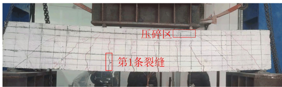
图 9 LA-1 梁裂缝分布
