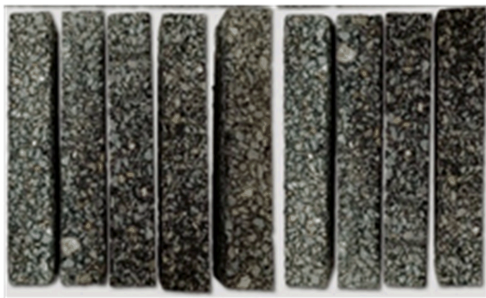
图 1 三点弯曲疲劳试验成型试件图
