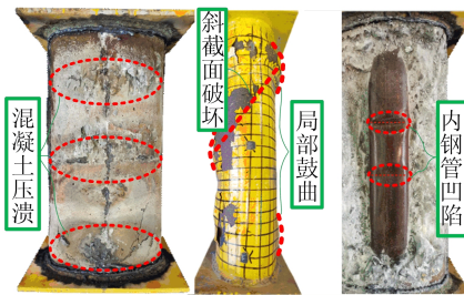
(b) 中空夹层椭圆钢管混凝土短柱
