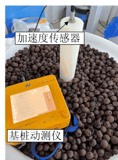
(b) 模型桩测试
