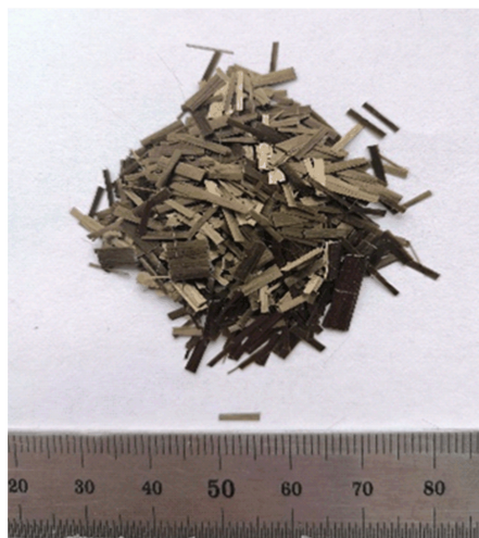
图 1 短切 6 mm 玄武岩纤维
