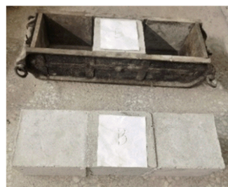
(b) 水下不分散混凝土-桩身混凝土抗剪试件
