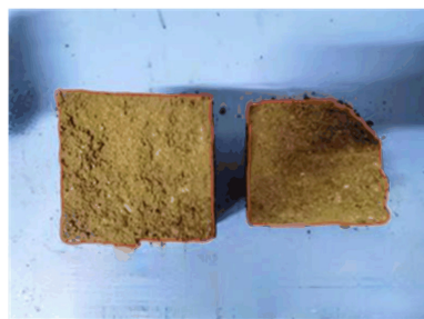
图 9 土体-水下不分散混凝土抗剪破坏界面
