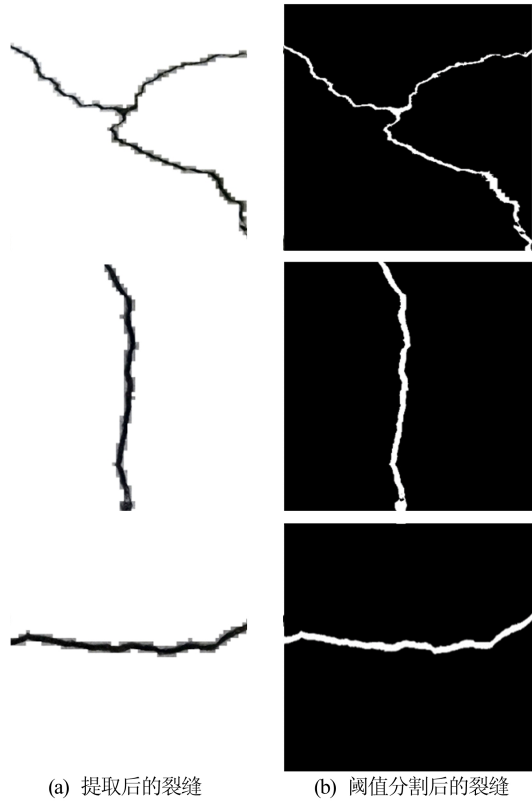
图 11 桥梁表面裂缝阈值分割结果
