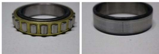
图 5 滚动轴承滚动体和内圈单点故障图
