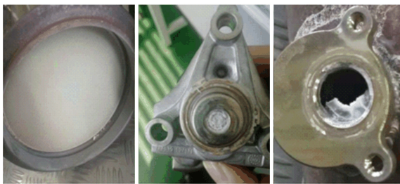
图 15 优化后 SCR 系统的尿素结晶
