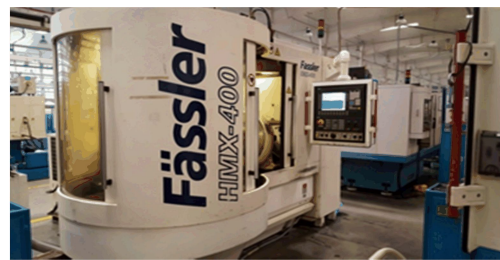
图 7 Fassler HMX-400 数控珩齿机现场加工图
