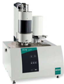
图 1 德国耐驰 STA449F5 型热分析仪
