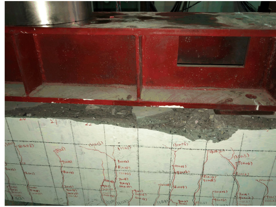
(b) 受压区混凝土压碎
