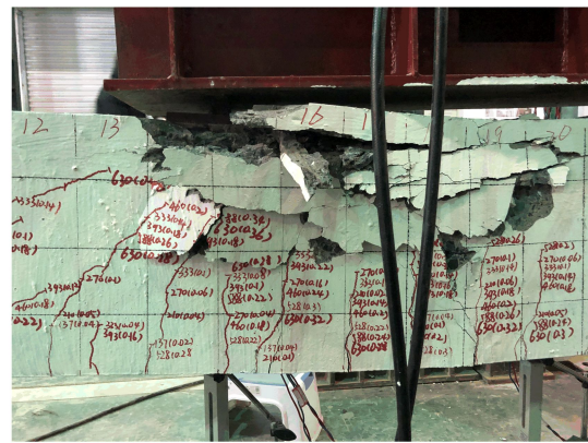
(b) 受压区混凝土压碎
