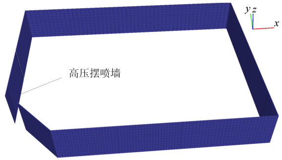
图 5 基坑最初防渗体系数值模型
