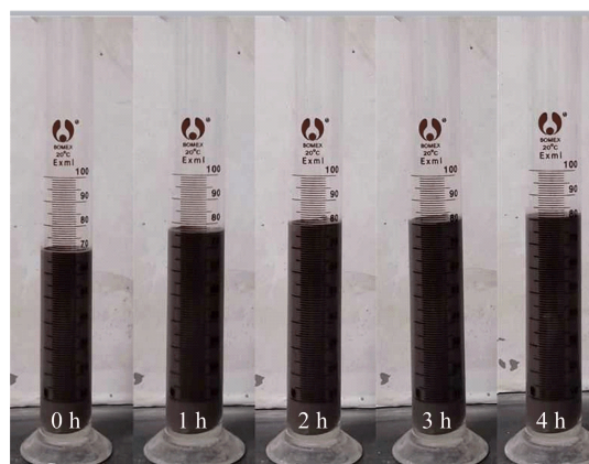
图 2 充填浆体膨胀高度随时间变化情形
